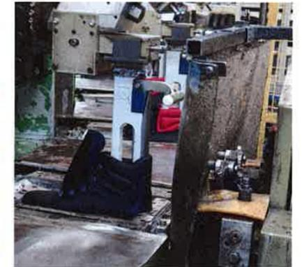
On voit ici une tige cardée au-dessus du moule d'injection de la semelle intermédiaire sur lequel est disposée la semelle d'usure en caoutchouc. Sur la photo suivante, la forme a été descendue, la tige épousant la forme du moule d'injection. Le polyuréthane liquide est alors injecté entre la semelle d'usure et la première de montage. Il sera totalement stabilisé environ 72 heures après l'injection.
