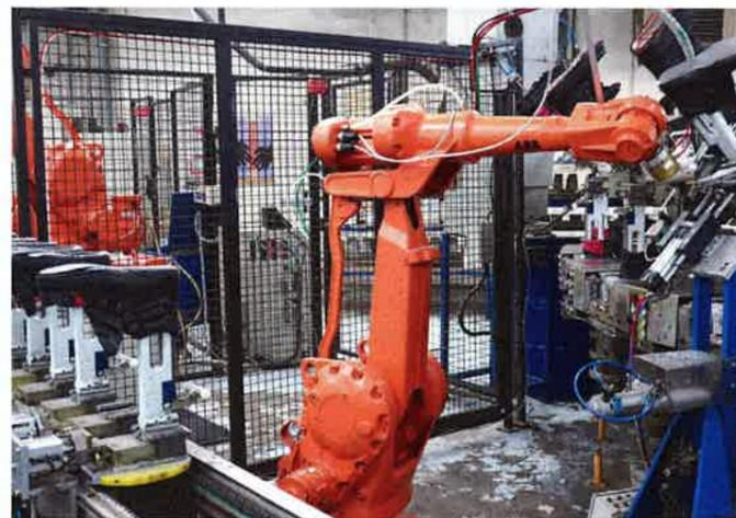
Un troisième robot assure le transfert des formes revêtues des tiges cardées de la chaîne de préparation au carrousel d'injection d'une capacité de 24 pieds, soit 12 paires de chaussures.
