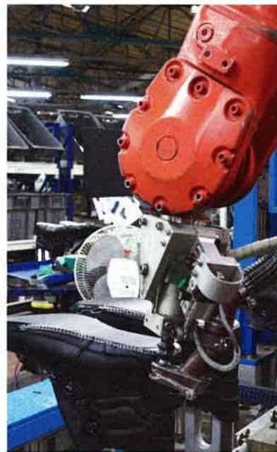
C'est ensuite au tour du robot de cardage d'entrer en action et de réaliser avec une fraise un usinage superficiel de la tige, adapté au modèle et à la peinture de la chaussure, ce qui favorisera la liaison de la semelle avec la tige.
