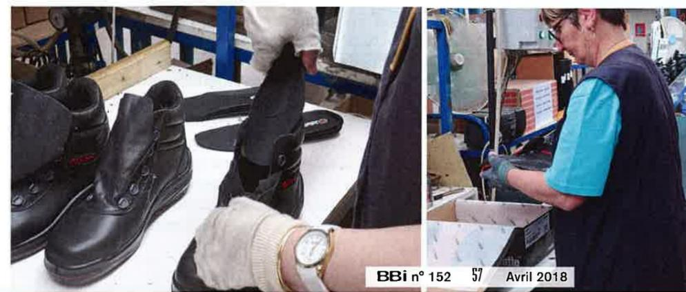
La semelle de propreté est placée manuellement dans les chaussures avant que celles-ci ne soient disposées dans leurs boîtes dûment étiquetées (les cartons de sur-conditionnement le sont également), accompagnées d'une notice d'utilisation. Avant la mise en boîte des chaussures, un ultime contrôle de la présence de l'intercalaire en acier est réalisé pour une sécurité assurée.
