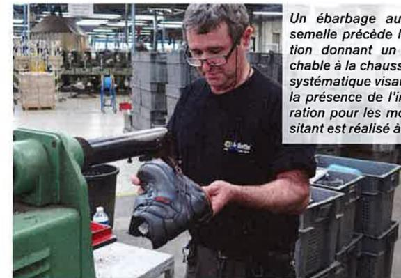
Un ébarbage automatisé de la semelle précède la phase de finition donnant un aspect irréprochable à la chaussure. Un contrôle systématique visant à s'assurer de la présence de l'insert anti-perforation pour les modèles le nécessitant est réalisé à ce même poste.
